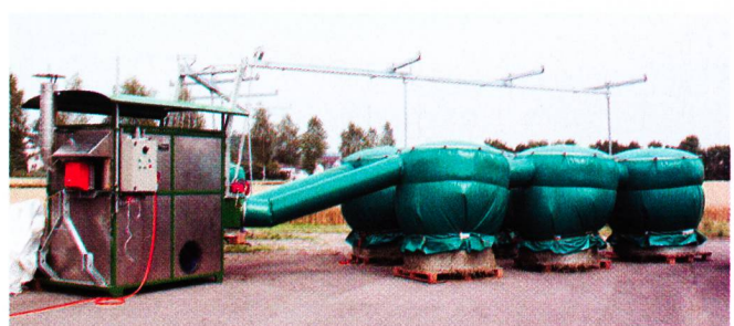
Fig. 4: L'installation de séchage Tecnomat pour balles rondes a demandé un investissement plus élevé, et consomme moins d'énergie.
