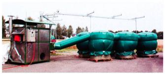
Fig. 4: L'installation de séchage Tecnolam pour balles rondes a demandé un investissement plus élevé, et consomme moins d'énerqie.
