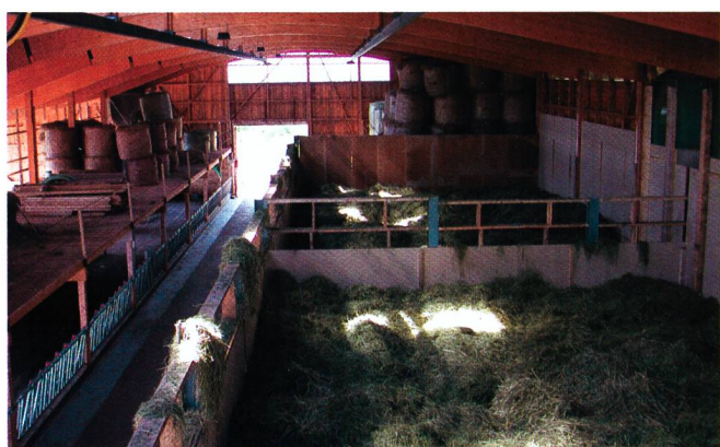
Fig. 5. Les locaux de stockage du fourrage en vrac sont plus grands que les locaux consacrés aux balles; ils doivent également être équipés de dispositifs pour manœuvrer le fourrage.
