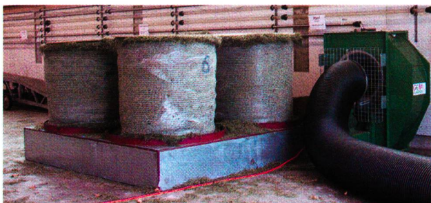
Fig. 3: L'installation de séchage GEBA pour balles rondes a demandé moins d'investissement, mais consomme beaucoup d'énergie.
