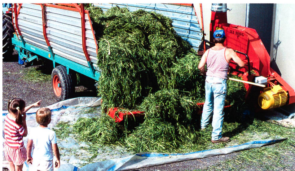
Une mécanisation individuelle simple, comprenant l'autochargeuse, le tapis d'alimentation et le souffleur, fonctionne parfaitement. Les avantages en matière de coûts se paient par un travail manuel astreignant et des performances modestes. (Photo: Paul Müri)
