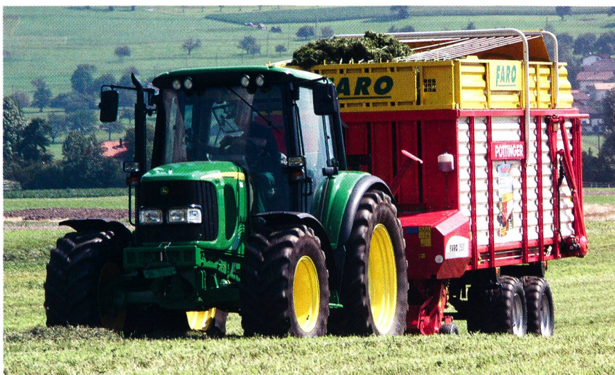
Les autochargeuses à coupe courte sont en mesure de préparer un fourrage aussi fin que les ensileuses automotrices. Elles s'imposent en fait lors de distances de transport courtes et lorsqu'une chaîne d'ensilage intensive en main-d'œuvre et en capital n'est pas indispensable. (Photo: Ueli Zweifel)
