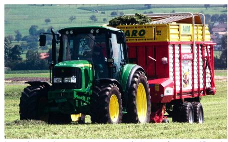
Les autochargeuses à coupe courte sont en mesure de préparer un fourrage aussi fin que les ensileuses automotrices. Elles s'imposent en fait lors de distances de transport courtes et lorsqu'une chaîne d'ensilage intensive en main-d'œuvre et en capital n'est pas indispensable. (Photo: Ueli Zweifel )
