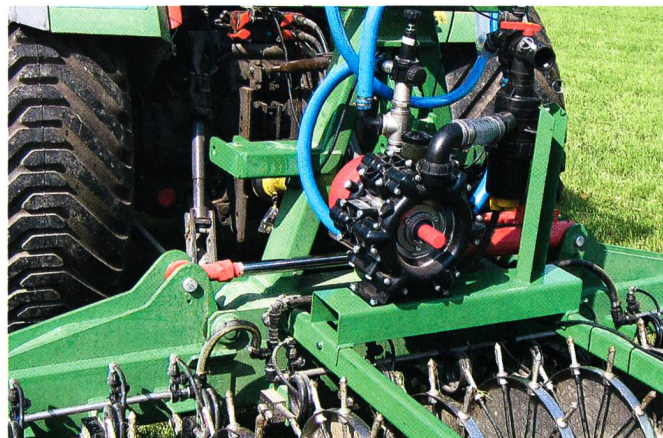
La pompe à membrane et la soupape de régulation de l'appareil d'injection sont commandées par un microprocesseur. La quantité souhaitée peut ainsi se régler indépendamment de la vitesse de travail. Le marquage à la mousse sur les extrémités des roues permet un départ précis dans n'importe quelle condition.
