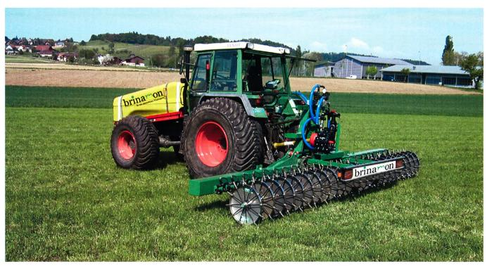
Injecteur à roue avec tracteur et réservoir d'engrais.
