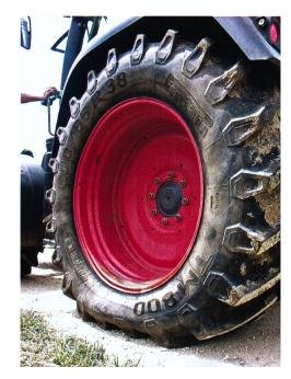
lement à l'essieu avant. Cela signifie que, dans tous les autres cas sauf la cabine suspendue, ce sont les pneus qui exercent la fonction de suspension. Cette fonction dépend d'ailleurs étroitement de la capacité de portance des pneus et de la vitesse maximale pour laquelle ils sont homologués.
