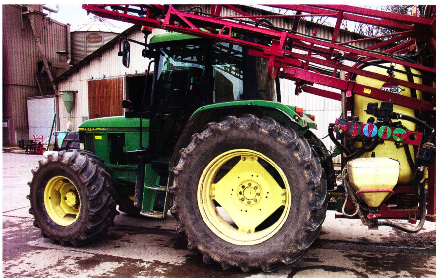
Pneus larges pour une capacité de traction élevée et une charge au sol spécifique faible. Plus tard dans l'année, on montera les pneus de cultures permettant de rouler dans les traces. (Photos: Ueli Zweifel)
