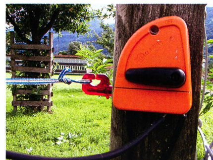
Grâce à un interrupteur de clôture, des secteurs du pâturage peuvent être enclenchés ou déclenchés.
