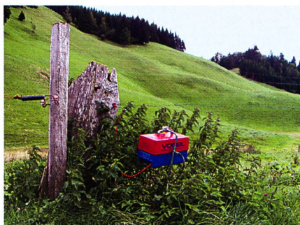
Pour le choix de l'emplacement de l'appareil, une bonne mise à terre s'avère primordiale.
