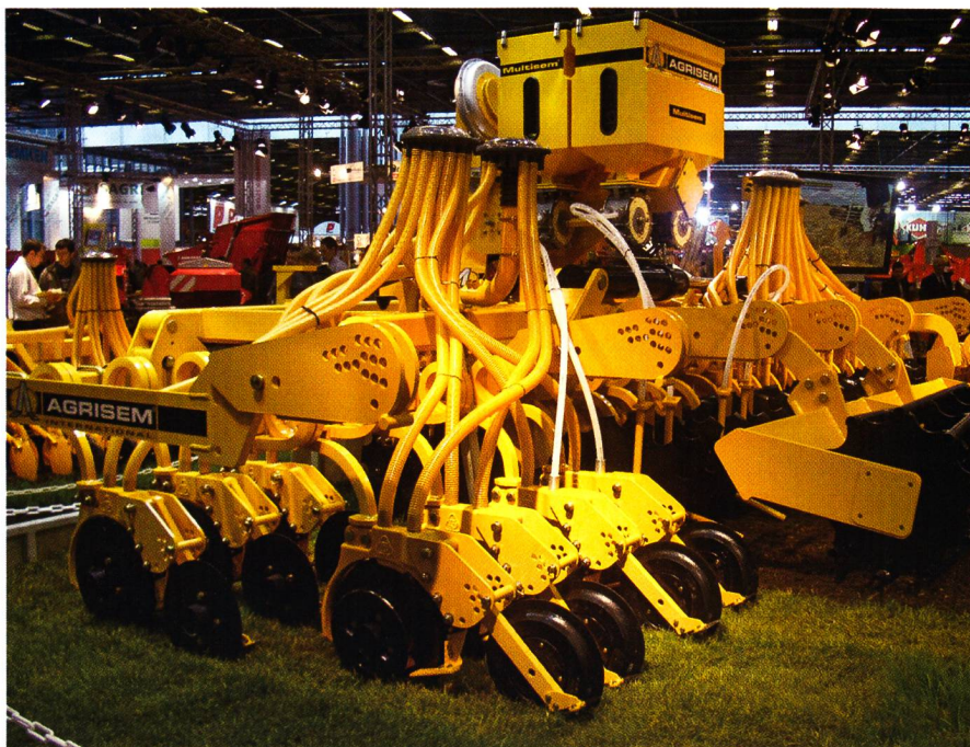
Fig. 2: Semoir de démonstration Agrisem Direct-O-Sem au SIMA 2007, équipé d'un système de dosage pneumatique central (tuyaux blancs).
