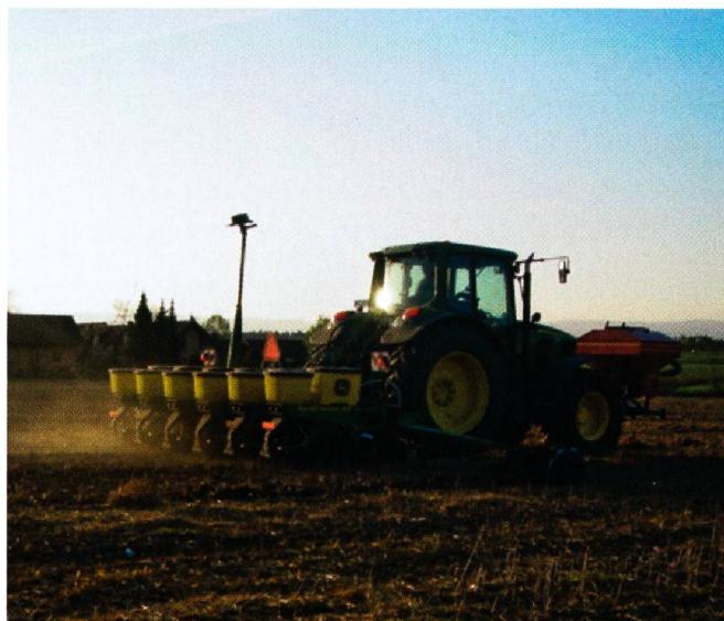
Fig. 4: Machine de semis direct à 6 rangs avec réservoir d'engrais fixé au système hydraulique frontal et transfert hydraulique du poids de l'essieu arrière sur le semoir afin d'augmenter la pression des socs (photo: Hanspeter Lauper).
