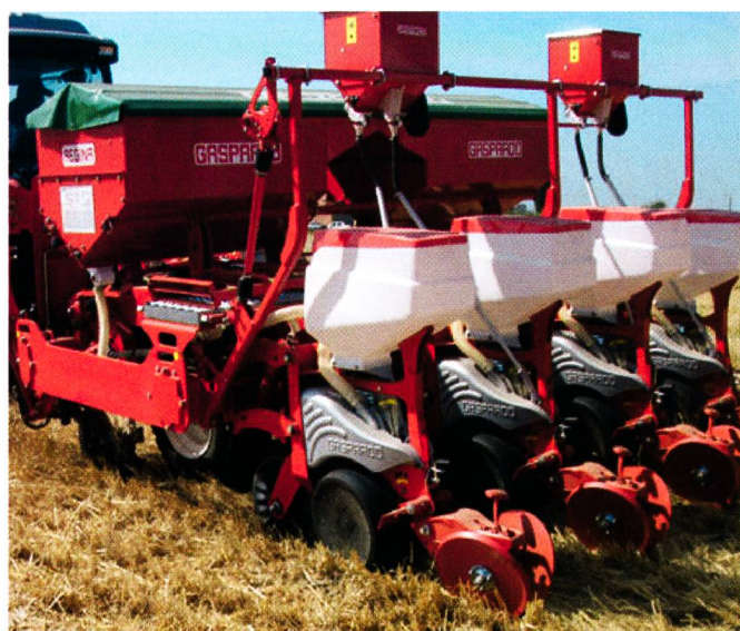
Fig. 3: Semoir à maïs tracté Gaspardo Regina pour le semis direct (photo usine).
