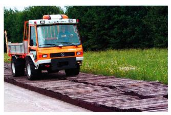
Fig. 3: Essais à des vitesses de 3, 4 et 5 km/h sur la piste accidentée normalisée de 35 m, qui présente les caractéristiques d'un champ labouré.
