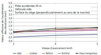
Fig. 15: Accélérations de vibrations verticales mesurées à la surface du siège des quatre transporteurs avec suspension comparés au vieux transporteur sans suspension; parcours sur la piste accidentée de 35 m avec véhicule vide.
