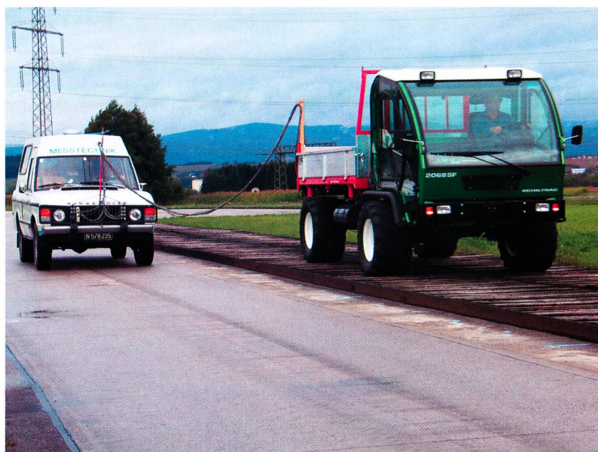
Fig. 1: L'exposition de la conductrice ou du conducteur aux vibrations a été évaluée de manière définie et reproductible sur des pistes accidentées normalisées.
