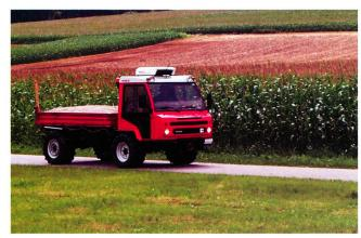
Fig. 4: Essais – ici avec une charge utile de deux tiers – à des vitesses de 30, 35 et 40 km/h sur une route secondaire asphaltée avec des zones défectueuses dans le revêtement.
