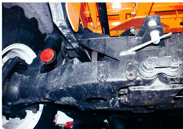
Fig. 8: Les essieux oscillants du Lindner Unitrac 95 sont formés d'un bras triangulaire simple de construction massive.
