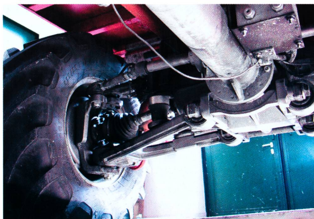
Fig. 7: Sur le Aebi TP 88, on voit bien le bras triangulaire transversal inférieur de cette suspension à bras oscillant transversal double. Derrière, on distingue le vérin de suspension rouge.
