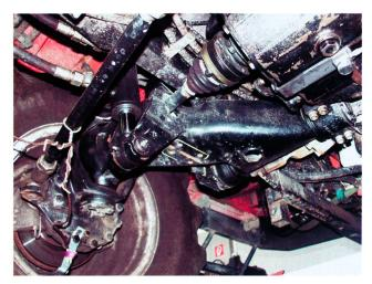
Fig. 9: La suspension de la roue du Reform T9 se caractérise par un bras oblique large qui repose contre le cadre du véhicule près de la roue avec le vérin de suspension. L'essieu portique permet d'obtenir une plus grande garde au sol.
