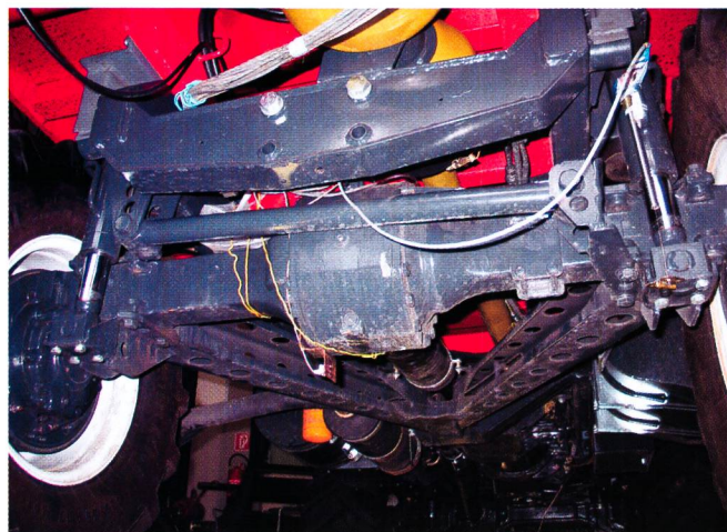
Fig. 10: Sur le Schiltrac 2068SF, les essieux rigides sont placés sur un long cadre triangulaire et sont articulés sur le cadre du véhicule devant les essieux. Les deux vérins de suspension servent de liaisons entre les essieux et le cadre à proximité des roues. On distingue bien le robuste stabilisateur latéral qui sert à absorber les forces latérales.
