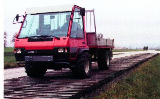
Fig. 2: Essais à des vitesses de 10 à 30 km/h sur la piste accidentée normalisée de 100 m, qui présente les caractéristiques d'un chemin de terre.
