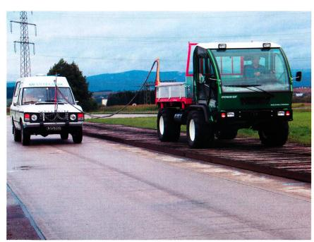
Fig. 1: L'exposition de la conductrice ou du conducteur aux vibrations a été évaluée de manière définie et reproductible sur des pistes accidentées normalisées.
