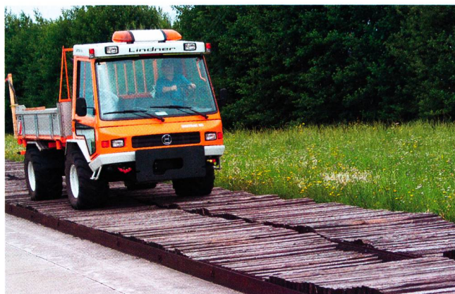
Fig. 3: Essais à des vitesses de 3, 4 et 5 km/h sur la piste accidentée normalisée de 35 m, qui présente les caractéristiques d'un champ labouré.
