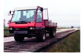
Fig. 2: Essais à des vitesses de 10 à 30 km/h sur la piste accidentée normalisée de 100 m, qui présente les caractéristiques d'un chemin de terre.
