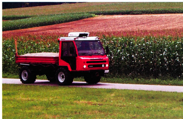
Fig. 4: Essais – ici avec une charge utile de deux tiers – à des vitesses de 30, 35 et 40 km/h sur une route secondaire asphaltée avec des zones défectueuses dans le revêtement.
