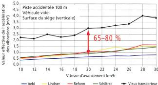
Fig. 11: Accélérations de vibrations verticales à la surface du siège des quatre transporteurs avec suspension comparés au vieux transporteur sans suspension; parcours sur la piste accidentée de 100 m avec véhicule chargé.
