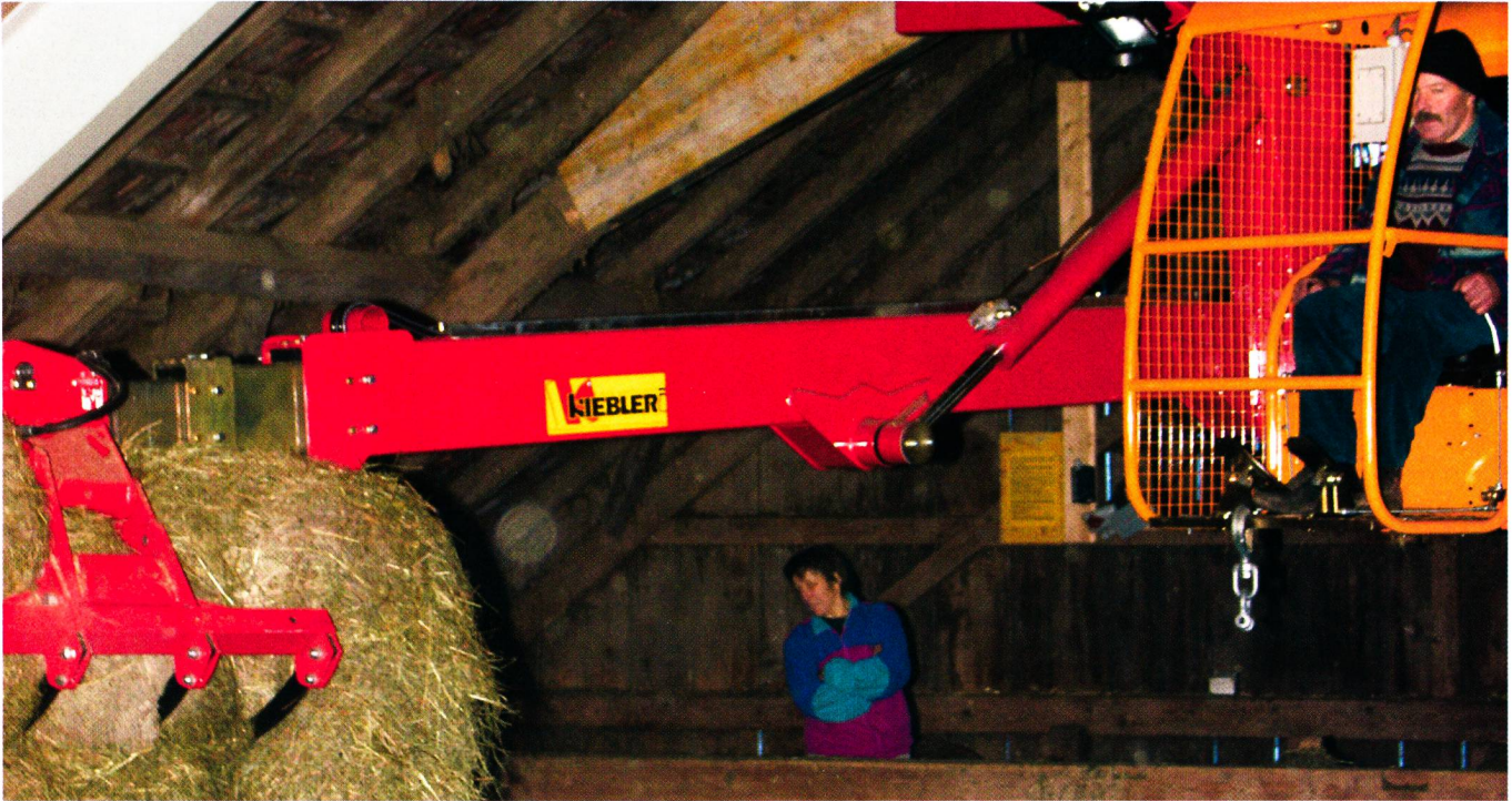
Les griffes télescopiques constituent une aide indispensable pour la logistique interne de l'exploitation. (photo: Ueli Zweifel)
