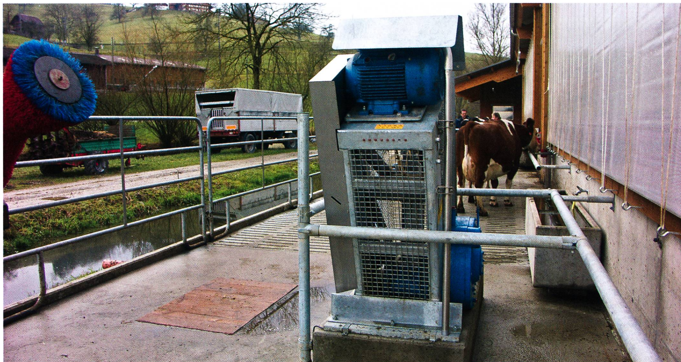
Brasseur à palette Fankhauser: le mouvement de balancier, qui met le lisier en mouvement en créant des vagues, nécessite une construction massive et robuste (photo: Ueli Zweifel).
