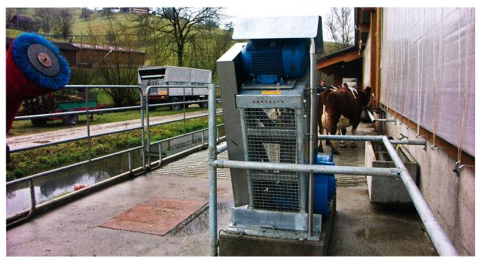
Brasseur à palette Fankhauser: le mouvement de balancier, qui met le lisier en mouvement en créant des vagues, nécessite une construction massive et robuste (photo: Ueli Zweifel).
