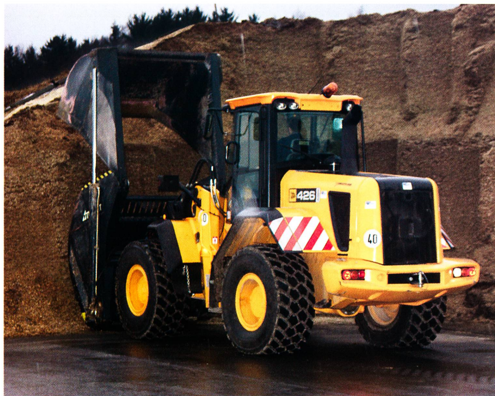
La technique la plus moderne de l'exploitation Probst avec une pelle de prélèvement spéciale permettant d'alimenter le mélangeur du fermentateur.
