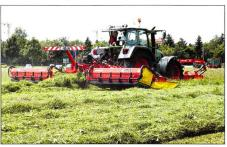
Les types SM 911 TL-KC et 911 TL-KCB sont équipés de série du conditionneur FELLA effective. Ce conditionneur muni d'un rotor à dents flexibles et d'un contre peigne à quatre positions produit une structure ondulée du fourrage perméable à l'air et ouvre la couche de feuillage supérieure pour faciliter l'élimination d'eau.
