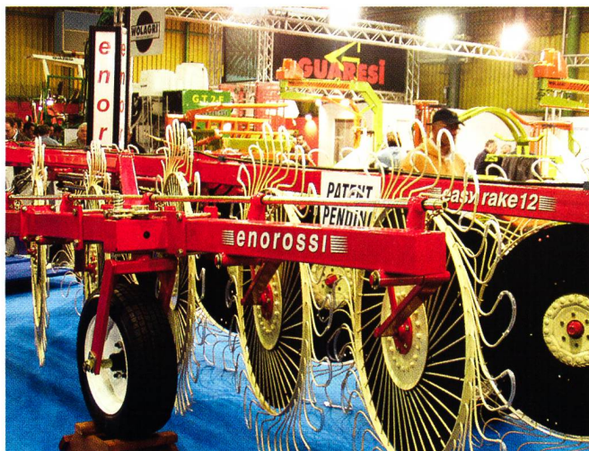
Les râteliers-soleils permettent des vitesses atteignant 20 km/h et assurent des performances à la surface considérables.
