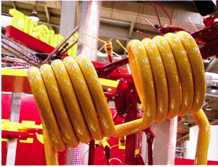
De nombreuses choses ont changé dans les faneuses à toupies, hormis les dents à ressort datant des années 60.
