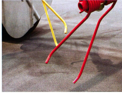
Les dents à ressort recourbées de Lely sont réputées ramasser le fourrage du sol particulièrement proprement.
