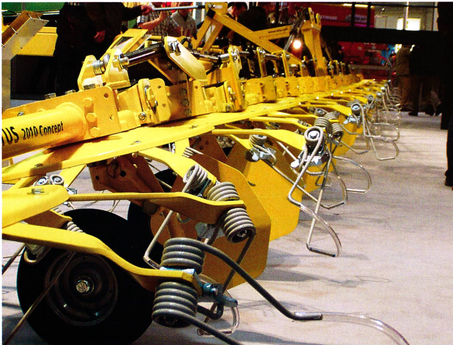
Surprenante largeur de travail d'une faneuse à toupies. Son entraînement nécessite un tracteur dès 70 kW.
