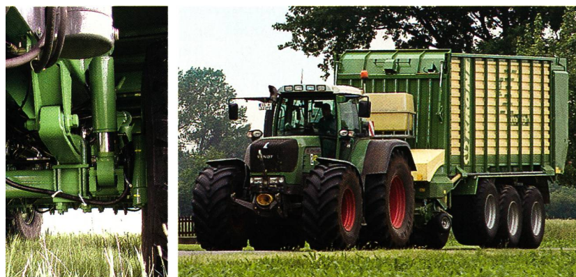
«Essieu tridem sur quatre roues pour trajets routiers» de Krone.
