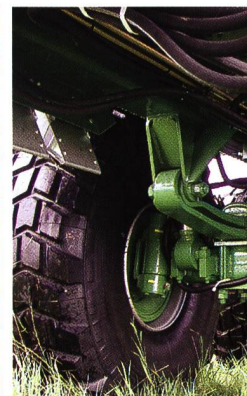
«Stabilisation hydraulique train roulant» de Bergma
