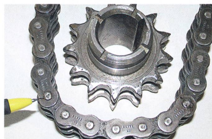
Des dents de pignons trop pointues usent excessivement la chaîne. Les pignons et la chaîne doivent être remplacés simultanément.
