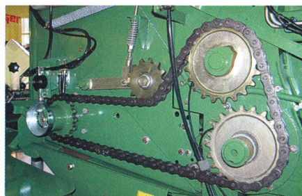
Les nouvelles chaînes, qu'elles soient posées lors de l'entretien courant ou lors d'une réparation ou sur les nouvelles machines, doivent être contrôlées et le cas échéant retendues après les premières heures de fonctionnement.
