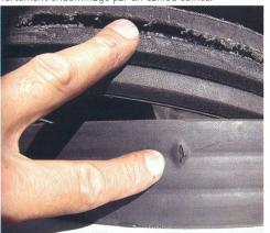
Les flancs de la poulie doivent être lisses et pla la courroie ne doit utiliser que les deux tiers extérieurs de la gorge.
