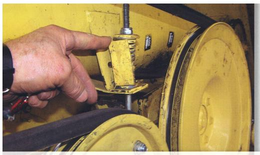
Cette languette métallique est un dispositif très simple pour indiquer la tension idéale du ressort. Ce dispositif fait également office de sécurité de surcharge de la courroie.
