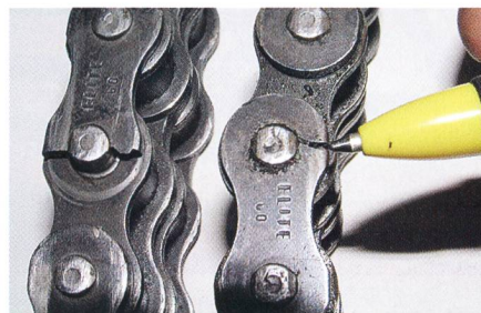
Cette chaîne double d'une hacheuse portée est très endommagée. Dégât provoqué par le pignon double irrégulièrement usé.
