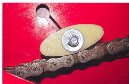
Ce guide-chaîne en matière synthétique empêche le flottage de la partie de la chaîne non chargée.
