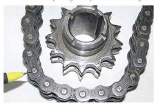
Des dents de pignons trop pointues usent exagérément la chaîne. Les pignons et la chaîne doivent être remplacés simultanément.
