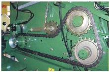
Les nouvelles chaînes, qu'elles soient posées lors de l'entretien courant ou lors d'une réparation ou sur les nouvelles machines, doivent être contrôlées et le cas échéant retendues après les premières heures de fonctionnement.
