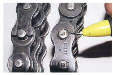
Cette chaîne double d'une hacheuse portée est très endommagée. Dégât provoqué par le pignon double irrégulièrement usé.
