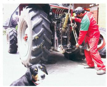
Dans la cour de sa ferme, Peter Ulrich contrôle si les deux bras inférieurs sont à la même hauteur et oscillent de façon équilibrée, une condition primordiale pour que la charrue réagisse de façon identique à droite comme à gauche. Ensuite, il vérifie encore la pression des pneus.
