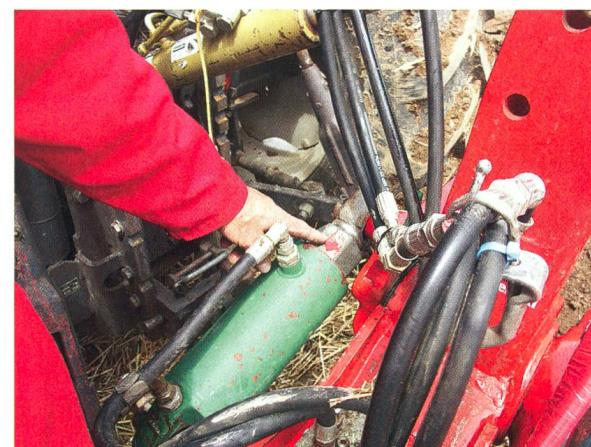
Vis de réglage pour que les corps de charrue forment un angle droit avec la surface du sol.
