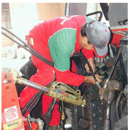
Une solution confortable: quatre raccords et les cylindres hydrauliques ad hoc pour actionner le bras supérieur, la rotation de la charrue, la largeur de la coupe du premier corps de la charrue et le variomat.
