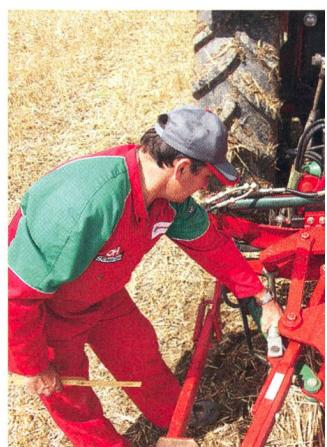
Vis de réglage pour ajuster le point de traction.
