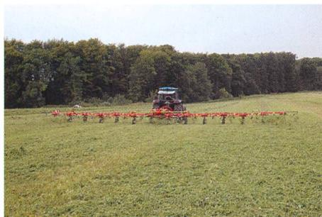
par les deux roues tâter régulables en hauteur et situées en amont dans le sens de la marche et les pneus super-ballons montés transversalement sous chaque toupie. Chaque toupie est montée sur un cadre guidé.
