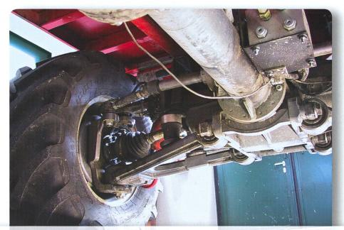
La suspension hydropneumatique indépendante des quatre roues du transporter réduit les effets des vibrations sur les sièges du véhicule à une valeur acceptable, tout en améliorant les propriétés de conduite et la sécurité.
