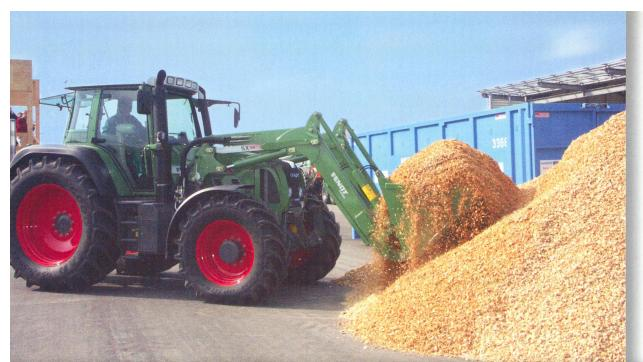
Grâce au développement de la technique des tracteurs, les chargeurs frontaux s'affirment pour la manutention de biens. A l'image, le nouveau chargeur frontal de Fendt. (Photo: Ueli Zweifel)
