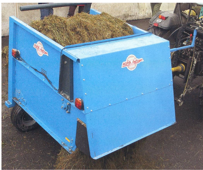
fig. 2: Dérouleur de balles fermé, tracté, avec fond mouvant et rouleau arracheur à couteaux pour la distribution. Les dérouleurs fermés ne peuvent recevoir que des balles rondes bien formées en raison de leurs dimensions réduites. (photo: S. Schrade, Agroscope ART)
