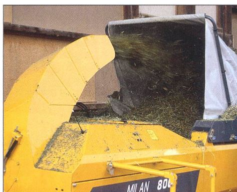
fig. 7: Les mélangeuses circulaires ou à turbine sont moins répandues. Elles sont également adaptées à l'épandage de paille. (photo: F. Nydegger, Agroscope ART)
