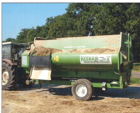
fig. 8: Les mélangeuses à brasseur ménagent particulièrement le fourrage. Elles sont moins bien adaptées pour mélanger des fourrages à longs brins comme le foin ou la paille. (photo: H. Brunken, Agroscope ART)
