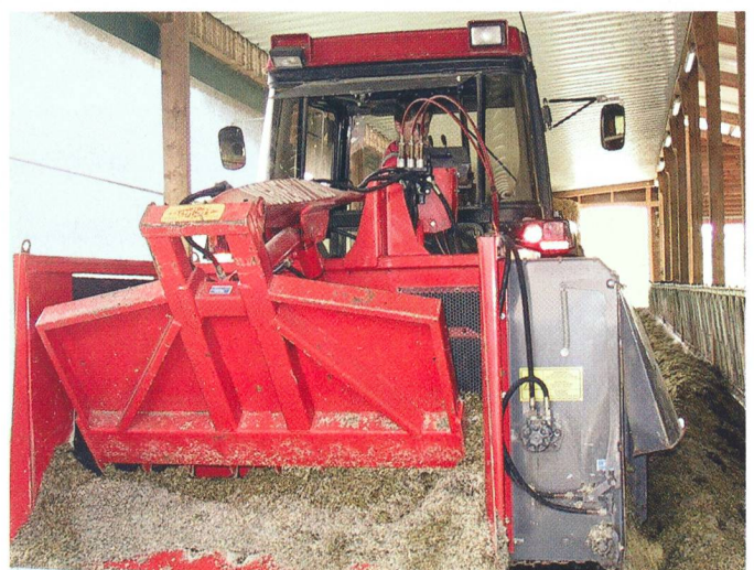
fig. 4: Les appareils de reprise, transport et distribution fixés aux trois-points offrent une bonne maniabilité, mais nécessitent des tracteurs relativement puissants. La reprise se fait ici avec une griffe de désilage. (photo: R. Stark, Agroscope ART)
