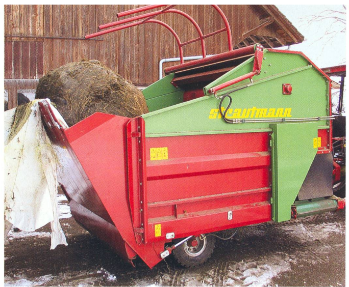
fig. 3: Une remorque distributrice bloc universelle avec plaque de chargement, traitant ici une balles ronde, ne peut être alimentée qu'avec du fourrage ouvert. (photo: S. Schrade, Agroscope ART)
