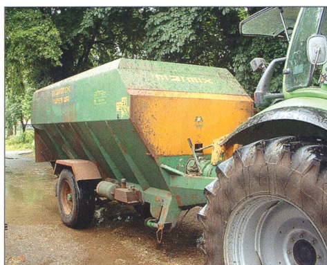
fig. 5: Les remorques mélangeuses horizontales comptent de 1 à 4 vis. Compte tenu de leurs dimensions, elles sont bien adaptées pour les passages bas et étroits. (photo: H. Brunken, Agroscope ART)
