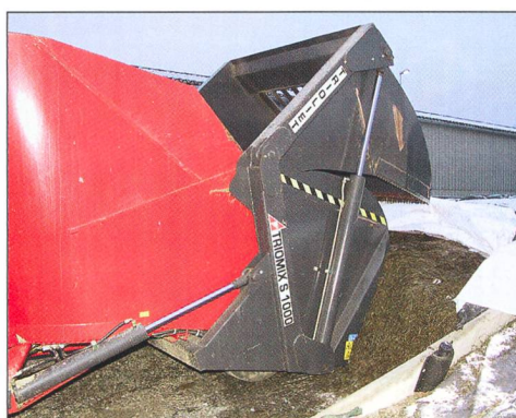
fig. 6: Les remorques mélangeuses verticales sont en général équipées d'une vis, voire plusieurs récemment (plus compactes). Des modèles avec systèmes de reprises sont également disponibles. (photo: F. Nydegger, Agroscope ART)
