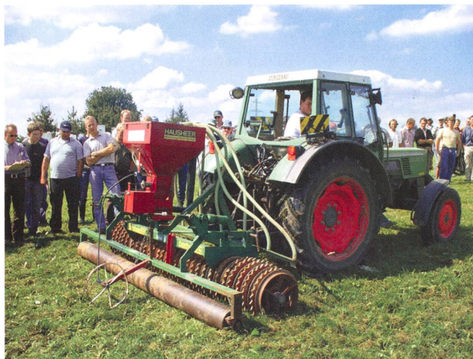
Les rouleaux lisses sont soutenus par la couche herbeuse existante et accomplissent leur travail moins bien que les rouleaux à la surface irrégulière.
