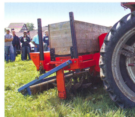
Groundhog: Une sorte de herse à bèches roulante qui déchire le feutrage et creuse des trous dans le sol.
