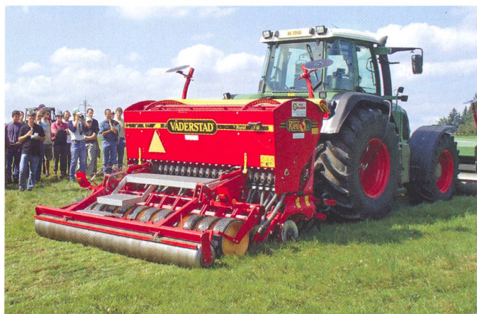
La pression élevée exercée par la machine de semis direct veille au dépôt des graines à la profondeur souhaitée.
