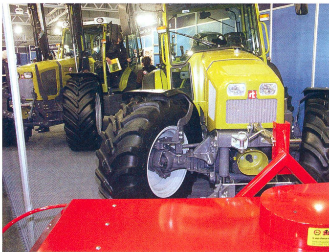
Sepp Knüsel présente son tout nouveau RigiTrac SKH 90 à l'Agritechnica. Ce dernier remplace le modèle SKH 80 qui est équipé d'un moteur 90 ch PS ISI avec refroidissement à eau (au lieu du mélange huile/eau). Photo Zw.
