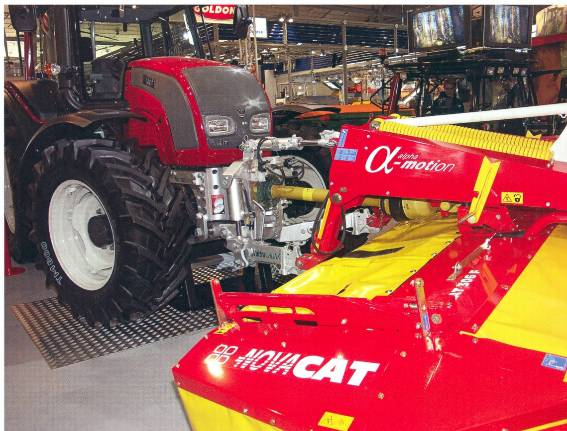
Le relevage frontal mobile suit automatiquement l'angle de braquage des roues avant jusqu'à 35°. Ainsi, le recouvrement des faucheuses en configuration frontale et arrière peut être nettement réduit.
