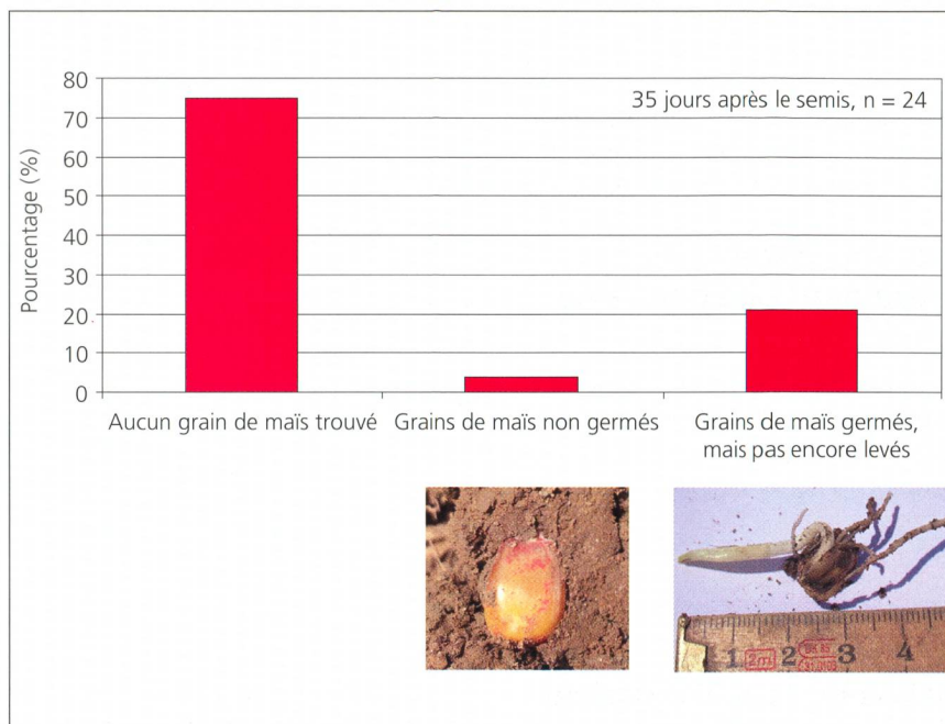
Fig. 4: Fouilles dans les zones lacunaires de maïs semé directement, 35 jours après le semis. 20 % des grains avaient germé, mais n'avaient pas encore levé au bout de 35 jours, 4 % des grains n'avaient pas germé.
