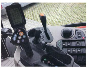
Toutes les fonctions importantes telles le powershift et le powershuttle (inverseur) et les commandes hydrauliques sont intégrées à l'accoudoir droit du «Multicontroller III».
