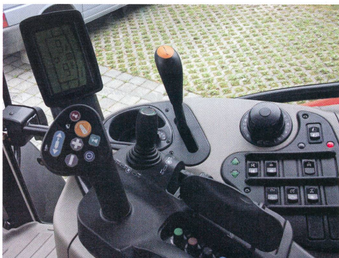
Toutes les fonctions importantes telles que le powershift et le powershuttle (inverseur) et les commandes hydrauliques sont intégrées à l'accoudoir droit du «Multicontroller III».
