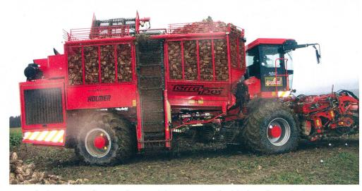
Les betteraves sucrières sont d'une grande importance pour l'exploitation et l'entreprise de travaux agricoles Pavillard: une technique de récolte moderne assure la capacité et les performances. La grande surface de contact des pneus abaisse la pression sur le sol.
