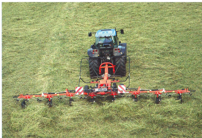
Turbo-faneuses TH 901 et 1101 avec attache au tracteur basse. Grâce à une commande hydraulique successive des opérations, les toupies extérieures se déplacent, les parties latérales se relèvent et le châssis de transport se met en place, ce qui met la machine en configuration transport (et inversement).
