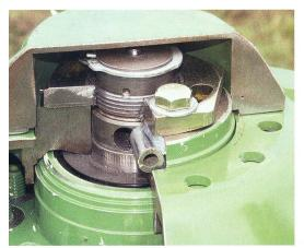
... Le système SafeCut de Krone: Ce système empêche les dommages et les arrêts importants grâce à une sécurité contre les corps étrangers de conception nouvelle. Après la rupture d'une goupille sous tension, le disque bloqué est éjecté de la surface des autres disques en quelques fractions de secondes, ce qui évite d'autres dégâts...
