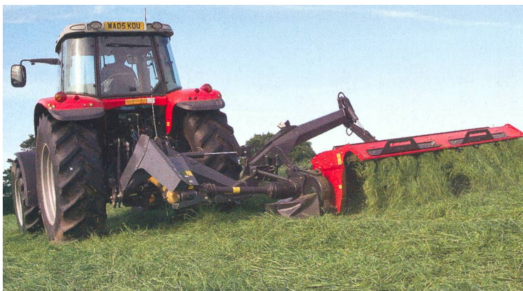
Faucheuses-conditionneuses arrière portées et tractées de Vicon (Kverneland) avec suspension. Celle-ci garantit une adaptation au sol incomparable.
