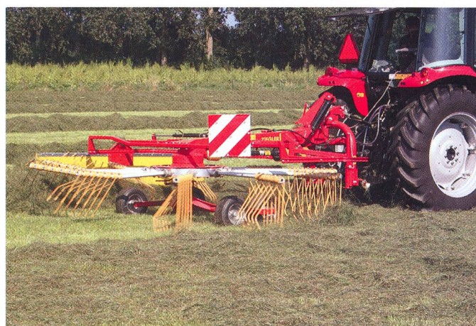
Série d'andaineurs «Twin-Disc» dans les variantes à une, deux ou quatre toupies. Deux cloches de grandes dimensions supportent les bras porte-dents, ce qui évite tout entretien. Les dents secondaires en biais assurent un prélèvement propre du fourrage à vitesse élevée également.
