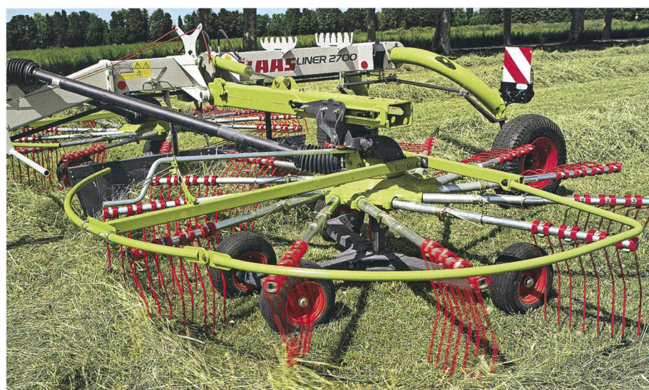
Les Liner 2600 / 2700 / 2800 remplacent les andaineurs concentriques 680 / 780 / 880 profi. Les toupies suspendues, mobiles de tous côtés, sont équipées en série d'un châssis à quatre roues. Sans rabattre les porte-dents, une hauteur inférieure à 4 m est atteinte.
