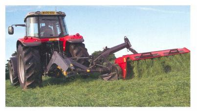
Faucheusesconditionneuse arrière portées et tractées de Vicon (Kverneland) avec suspension. Celle-ci garantit une adaptation au sol incomparable.
