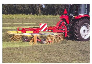
Série d'andaineurs «Twin-Disc» dans les variantes à une, deux ou quatre toupies. Deux cloches de grandes dimensions supportent les bras porte-dents, ce qui évite tout entretien. Les dents secondaires en biais assurent un prélèvement propre du fourrage à vitesse élevée également.
