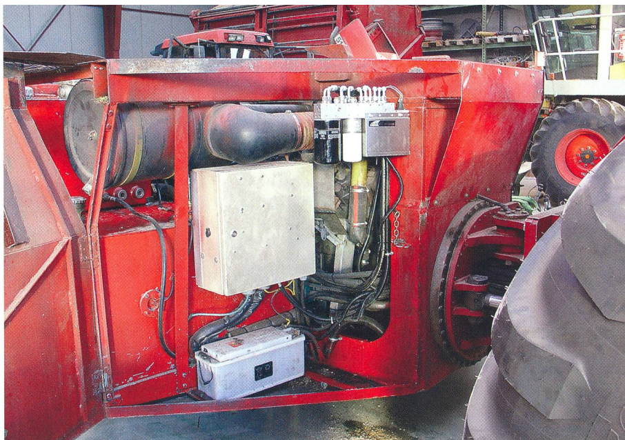
Les améliorations apportées aux kit de bicarburation permettent de gérer électroniquement la proportion d'HVP mélangée au diesel. Ici un kit de type Biotec sur une déchiqueteuse «faite maison» de l'entrepreneur de travaux agricoles, Peter Stühli à Suberg)
