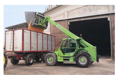
**Merlo:** Panoramic P 55.9 CS avec turbodiesel de 140 CV ainsi qu'un nouveau châssis et un bras renforcé, va loin en ce qui concerne les performances et les capacités de charge des chargeurs à pneus.
