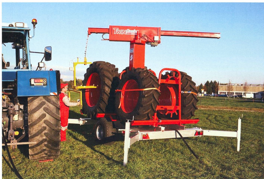
33 nouveautés ont obtenu une médaille d'argent, parmi elles le Twin Carrier des frères Schaad AG à Subingen SO. Cet appareil permet de monter des roues jumelées seul, même sur une surface irrégulière.
