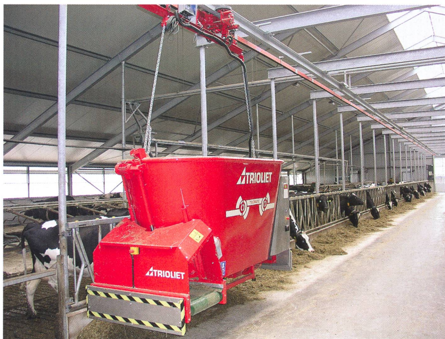
Trioliet: Système d'alimentation automatique Triomatic: L'automate prélève les composants du fourrage enregistrés selon la recette programmée.
