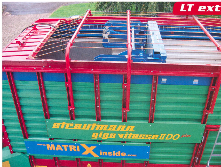
Strautmann: La nouvelle autochargeuse grand volume Giga-Vitesse DUO peut être équipée d'une paroi mobile MatriX qui se déplace d'avant en arrière avec le fonds mobile et permet d'emblée une compression adéquate du fourrage récolté. Pour le déchargement, la paroi se relève, puis se rabat en avant.
