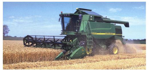
John Deere expose quatre nouvelles séries de moissonneuses-batteuses S, C, T, W. La série T, avec quatre modèles de base de 290 à 400 CV, a un concept de battage entièrement nouveau avec un tambour de battage de 660 mm et un tambour d'alimentation intermédiaire de 420 mm. Le paquet Autotrac (guidage automatique), HarvestSmart (réglage automatique du débit) et HarvestDoc (enregistrement du rendement et des données de récolte) justifie la désignation «i» pour intelligence.
