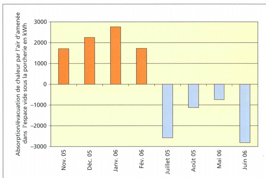
Fig. 16: Absorption ou évacuation de la chaleur de l'air d'amenée dans la cavité située sous la deuxième porcherie Krieger durant les mois d'hiver et d'été.
