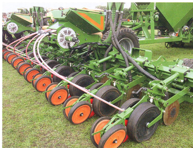
Semoir monograin: tout nouveau principe avec distributeur central des grains.
