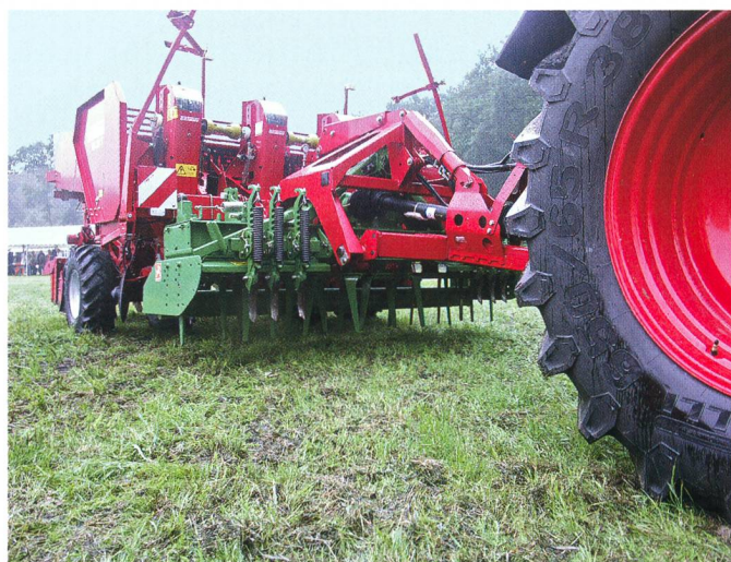
Automate enfouisseur combiné avec un chisel rotatif réglable.
