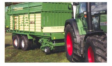
Nouvelle autochargeuse AX avec fond mouvant incliné et barre de coupe oscillante.
