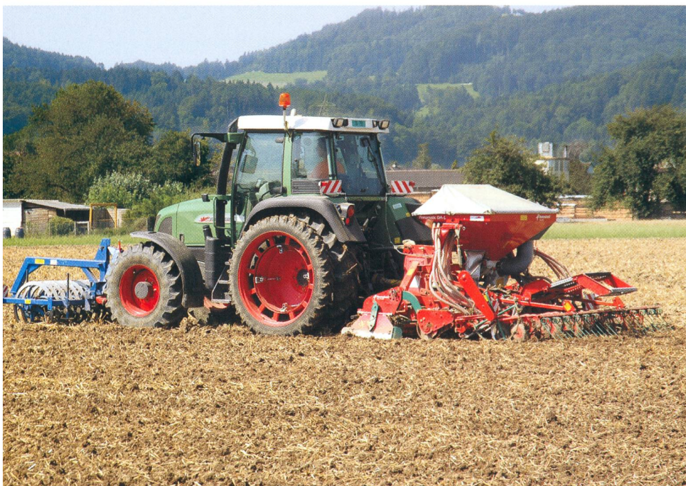
Fig . 2: Les semoirs pneumatiques se manient simplement et le réservoir à grains se vide facilement. La précision de semis n'est cependant pas meilleure que celle des semoirs mécaniques.
