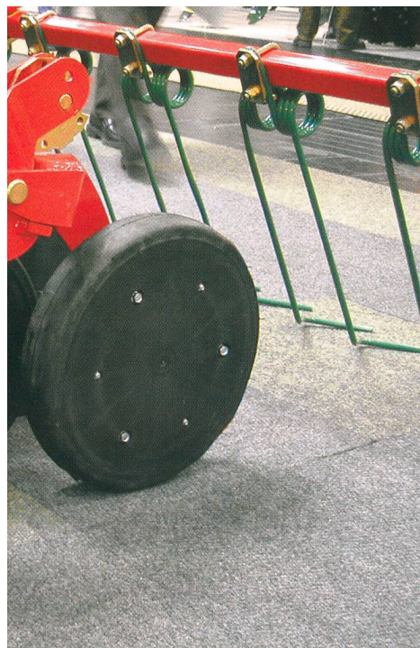
Fig. 1: Par rapport aux socs semeurs conventionnels exerçant une pression autour des 10 kg (à gauche), le guidage de socs à disques avec des pressions élevées (env. 80 kg) implique des roues de jauge complémentaires (à droite). Ils permettent de semer dans un lit de semences grossier comportant des résidus de paille.
