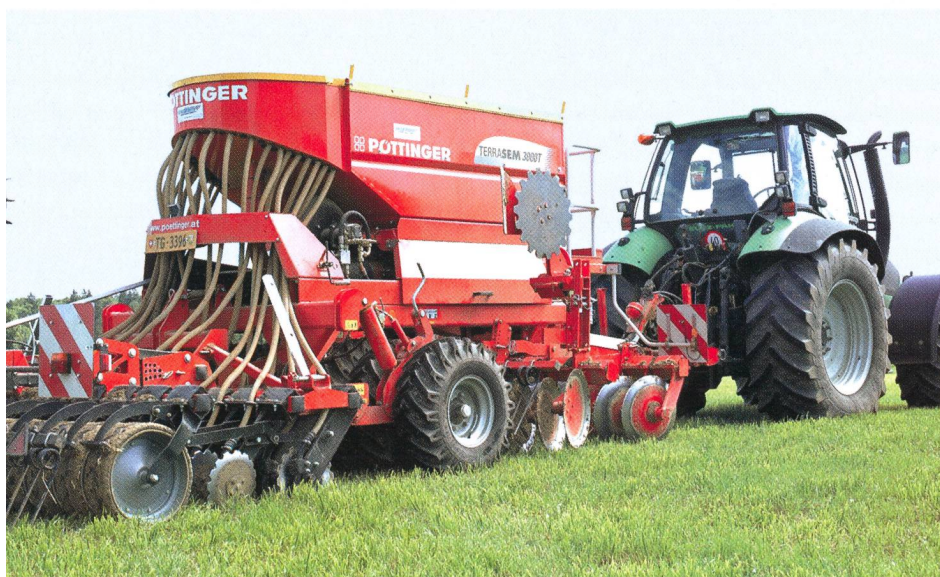
Fig. 6: Les semoirs deviennent de plus en plus complexes, raison pour laquelle l'électronique y prend une part accrue. Pour éviter d'équiper chaque machine d'un terminal de commande, le système ISO-Bus fait sa place sur ces machines également. Il est ainsi possible de commander celle-ci depuis le terminal du tracteur, un pas important vers l'avenir!
