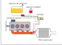
Un additif, généralement à base de fer, est ajouté au carburant, en très faible concentration (maximum 1‰). Après la combustion, l'additif est réparti de manière homogène dans la suie. Il fonctionne comme un catalyseur et abaisse la température d'ignition de la suie.
