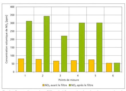
Fig. 6: Influence d'un système CRT sur le  $NO_2$  pour les six points de mesure. Avec les systèmes CRT, il peut se produire un excédent de  $NO_2$ , lorsque la quantité de  $NO_2$  oxydé dépasse la quantité nécessaire à la régénération. Mesures effectuées sur le tracteur Valtra 6350-4 rouge.
