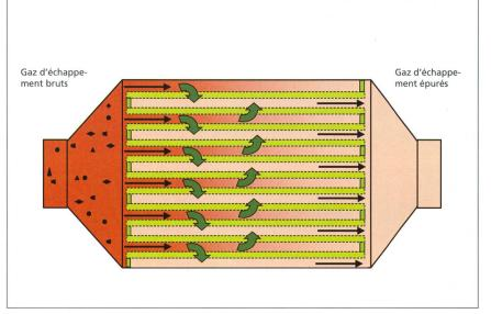
Fig. 2: Schéma d'un filtre à particules.
