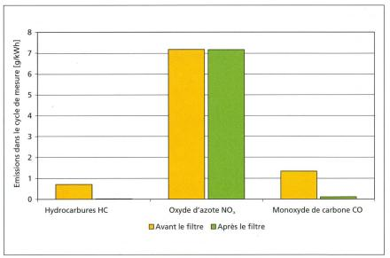
Fig. 5: Influence d'un système CRT sur les émissions des autres composants des gaz d'échappement dans le cycle de mesure: le CO et les HC sont réduits massivement, le  $NO_x$  reste tel quel. Mesures effectuées sur le tracteur Valtra 6350-4 rouge.
