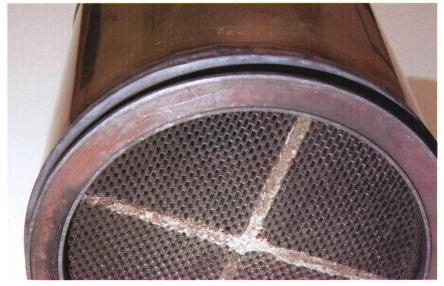
Fig. 1: Filtre à particules.
