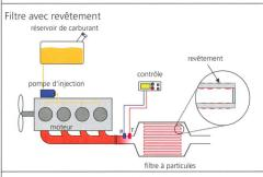
Lorsque la suie entre en contact avec le revêtement, de platine par exemple, elle réagit à l'oxygène à basses températures et se consume en dioxyde de carbone CO<sub>2</sub>. Là encore, suivant le revêtement, la réaction peut réduire les émissions d'hydrocarbures HC et de monoxyde de carbone CO, mais augmenter la production de NO<sub>2</sub>.
