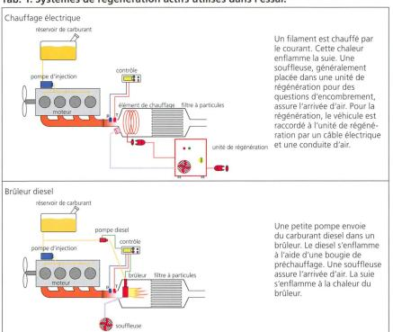
le filtre doit avoir une certaine dimension. Parmi les filtres à particules, on distingue les systèmes de filtres fermés décrits ci-dessus et les filtres dits ouverts ou également catalyseurs de particules, dans lesquels les canaux ne se ferment pas en alternance. Les systèmes ouverts étant beaucoup moins efficaces, ils n'ont pas été pris en compte dans la présente étude.
