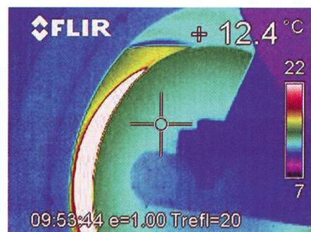
La caméra infra-rouge montre les parties échauffées de l'équipement de freinage. Les couleurs foncées de l'essieu (milieu-droite) et du pneu (à gauche) révèlent les températures basses. Le tambour de frein, par contre, est très chaud, surtout dans le secteur du dispositif de décharge (photo ART).
