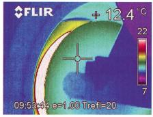
La caméra infra-rouge montre les parties échauffées de l'équipement de freinage. Les couleurs foncées de l'essieu (milieudroite) et du pneu (à gauche) révèlent les températures basses. Le tambour de frein, par contre, est très chaud, surtout dans le secteur du dispositif de décharge (photo ART).
