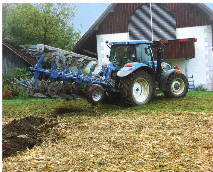
III. 4: Afin de garantir une conduite aisée, l'Ordonnance concernant les exigences techniques requises pour les véhicules routiers (OETV) précise que 20% du poids effectif doit reposer sur l'essieu avant.
