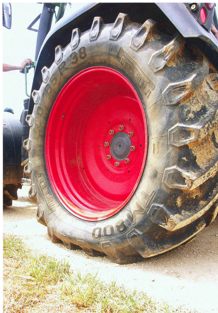
III. 5: La capacité porteuse des pneus dépend de la pression de gonflage et de la vitesse.
