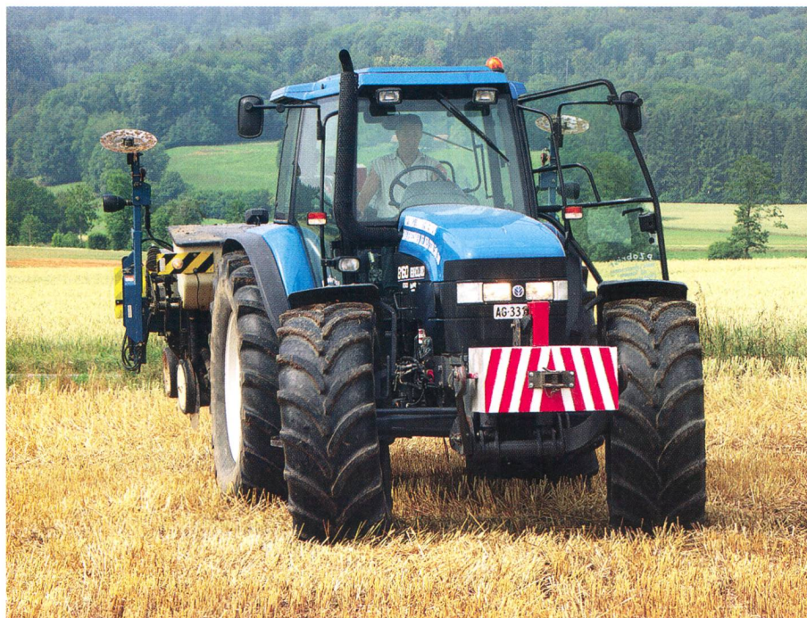
III. 6: Le lestage avant garantit une répartition favorable du poids effectif sur les deux essieux.
