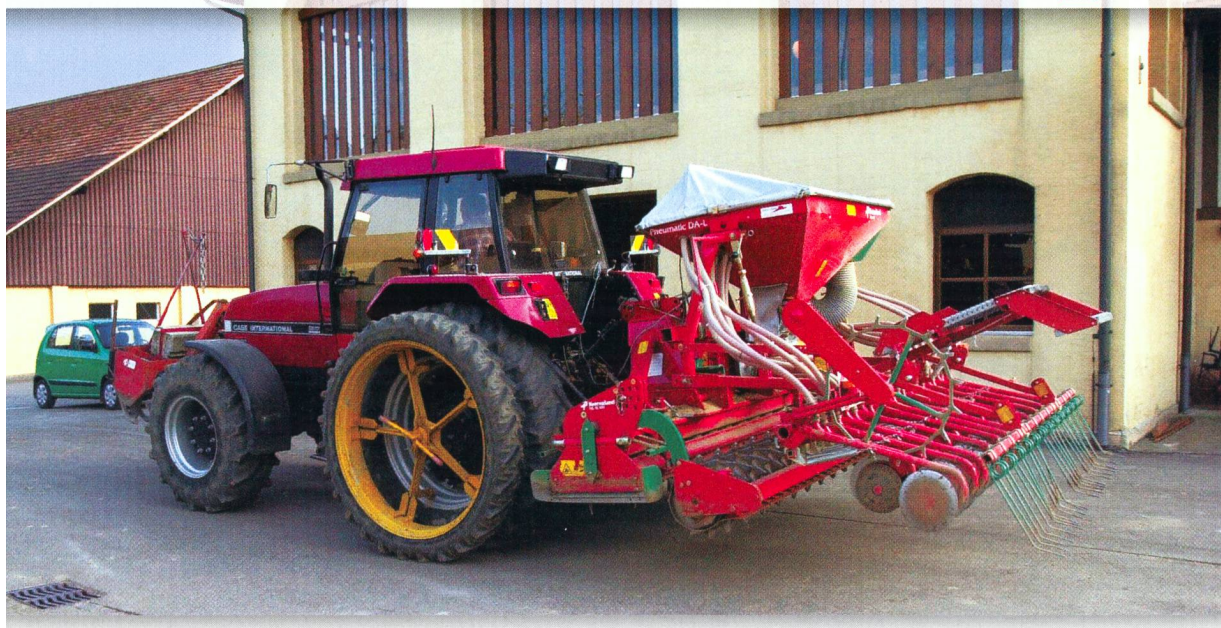
Ill. 1: Les outils portés dont le poids est élevé nécessitent d'importantes charges utiles.
