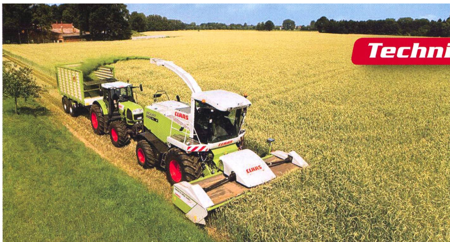
Récolte au GPS en un seul passage: Claas Jaguar avec dispositif de coupe directe «Direct-Disc 520».
