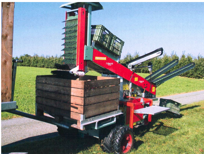
Ill. 2: Le remplisseur de caisse du Pluk-o-trak permet une répartition régulière de la récolte dans les paloxes.
