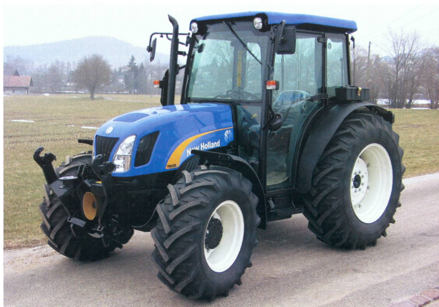
Fig. 2: Tracteur New Holland TN 85DA, moteur à aspiration 4 cylindres, 60 kW (82 ch), poids 3200 kg, rapport de test no 1905/06.
