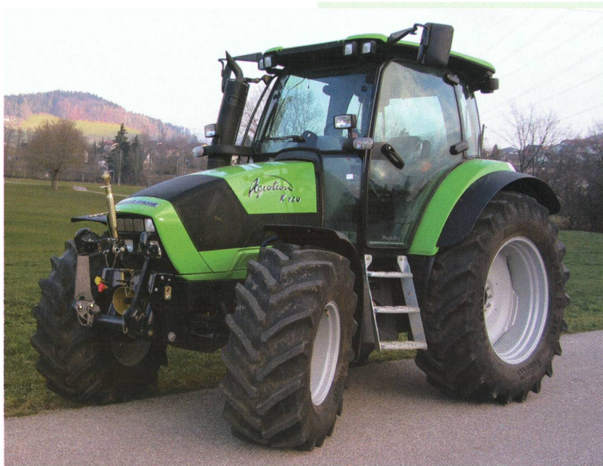
Fig. 6: Tracteur Deutz Agrotor K120 Profiline, moteur turbo 4 cylindres avec refroidissement d'air de suralimentation, 85 kW (115 ch), boîte de vitesse à passage sous charge – 3 paliers, système hydraulique frontal et prise de force frontale, suspension de l'essieu avant et de la cabine, poids 5350 kg, rapport de test no 1911/06.
