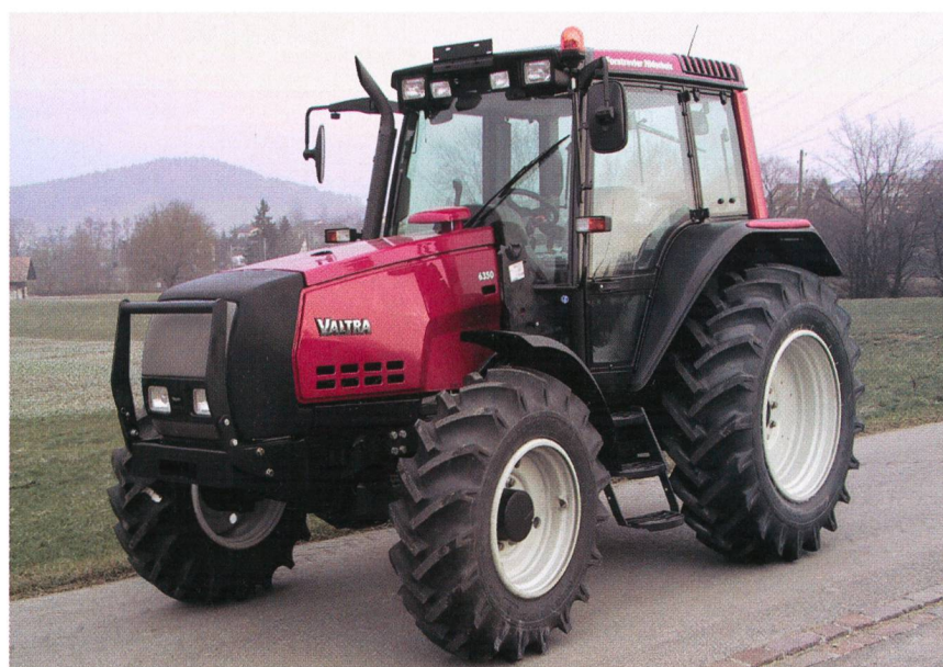
Fig. 1: Tracteur Valtra 6350-4, moteur turbo 4 cylindres, 74 kW (101 ch), boîte de vitesse à passage sous charge – 3 paliers, poids 4610 kg, rapport de test no 1902/06.
