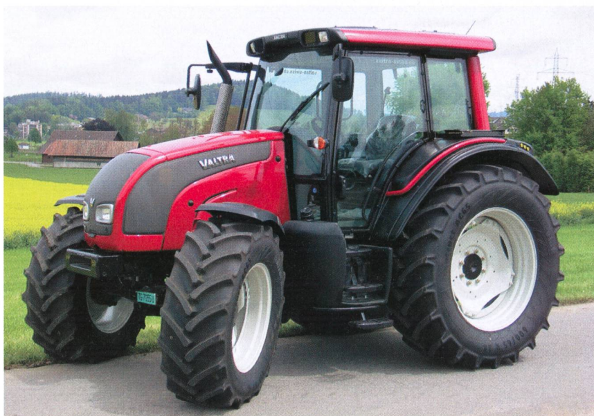
Fig. 4: Tracteur Valtra N121 HiTech, moteur turbo 4 cylindres avec refroidissement d'air de suralimentation, 93 kW (126 ch), boîte de vitesse à passage sous charge – 3 paliers, suspension de l'essieu avant, poids 5460 kg, rapport de test no 1909/06.
