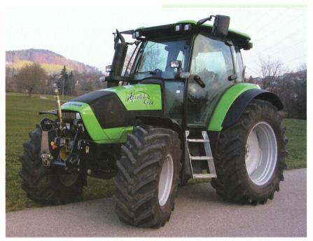
Fig. 6: Tracteur Deutz Agrotron K120 Profiline, moteur turbo 4 cylindres avec refroidissement d'air de suralimentation, 85 kW (115 ch), boîte de vitesse à passage sous charge – 3 paliers, système hydraulique frontal et prise de force frontale, suspension de l'essieu avant et de la cabine, poids 5350 kg, rapport de test no 1911/06.
