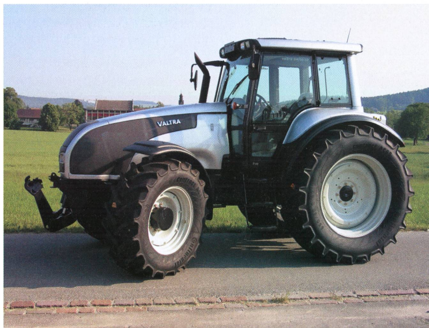
Fig. 5: Tracteur Valtra T170cH, moteur turbo 6 cylindres avec refroidissement d'air de suralimentation, 132 kW (180 ch), boîte de vitesse à passage sous charge – 3 paliers, système hydraulique frontal, suspension de l'essieu avant, poids 6650 kg, rapport de test no 1910/06.
