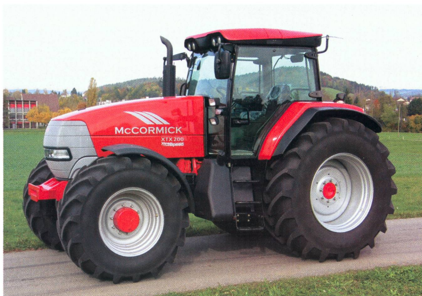
Fig. 3: Tracteur Mc Cormick XTX200, moteur turbo 6 cylindres avec refroidissement d'air de suralimentation, 134 kW (182 ch), boîte de vitesse à passage sous charge – 8 paliers, suspension de l'essieu avant et de la cabine, poids 7960 kg, rapport de test no 1903/06.
