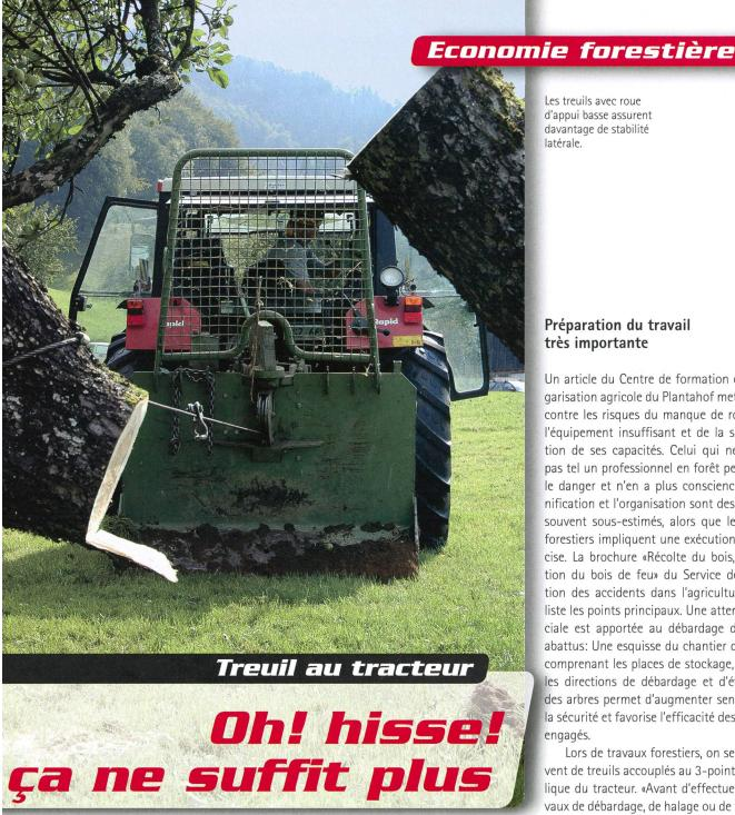
Le treuil fixé au relevage hydraulique 3-points du tracteur fait partie intégrante des travaux forestiers. Une formation adéquate, le choix correct du type de treuil et une planification exacte de l'abattage sont indispensables pour un travail en toute sécurité.
