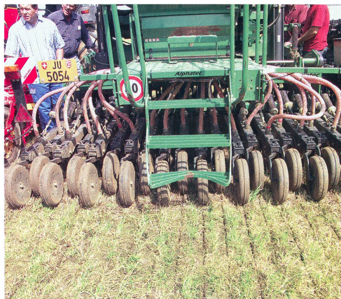
Après le semis direct – une fente de semis sinon rien: dépôt précis de la semence avec socs à disques de la marque américaine Great Plains, représentée par Alphatec.
