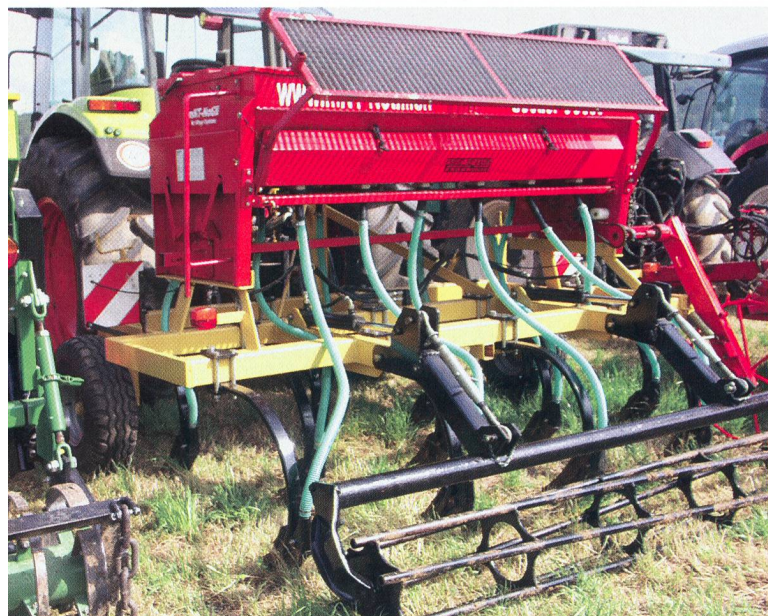
Technique de semis relativement simple avec socs à dents d'un pionnier du semis direct, Martin Häberli, Rosshäusern.
