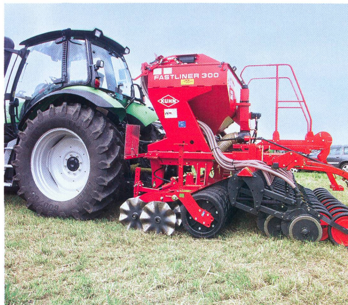
Semis direct Kuhn: Une articulation rotative à la hauteur du packer à pneu assure une conduite précise des socs semeurs dans la fente pratiquée par le disque rainuré.
