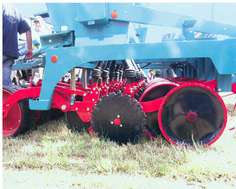
Construction compacte du Sulky Unidrill (Bovet SA) avec soc semeur monodisque et une conduite mécanique de la semence.
