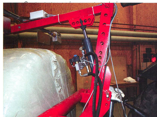
Le cylindre hydraulique est équipé d'une soupape électromagnétique et d'un dispositif de verrouillage.
