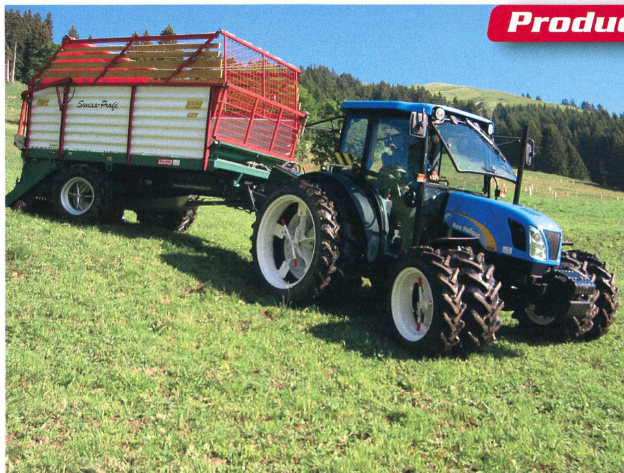
Tracteur avec châssis-remorque et essieu moteur-directeur de Urs Schmid, Littau. Une autochargeuse de la firme Lüönd est utilisée. Le timon articulé, commandé grâce à un capteur dans le pick up, améliore l'adaptation au sol.
