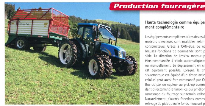
Tracteur avec châssis-remorque et essieu moteur-directeur de Urs Schmid, Littau. Une autochargeuse de la firme Lüönd est utilisée. Le timon articulé, commandé grâce à un capteur dans le pick up, améliore l'adaptation au sol.
