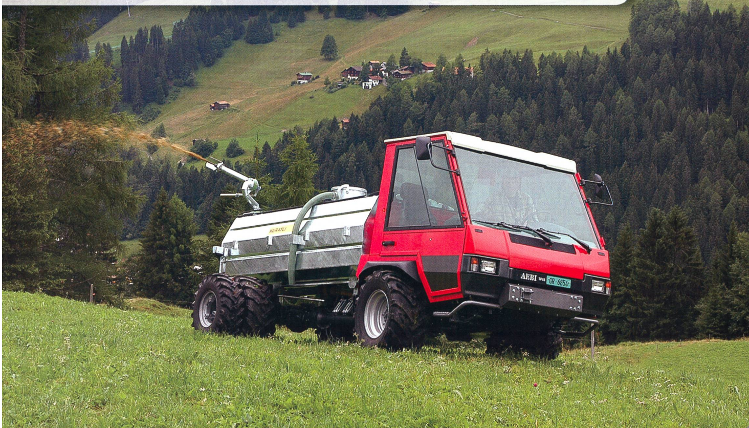
Transporter AEBI TP 68 avec citerne à pression Kuratli. La citerne est construite de façon à réduire au plus le centre de gravité.
