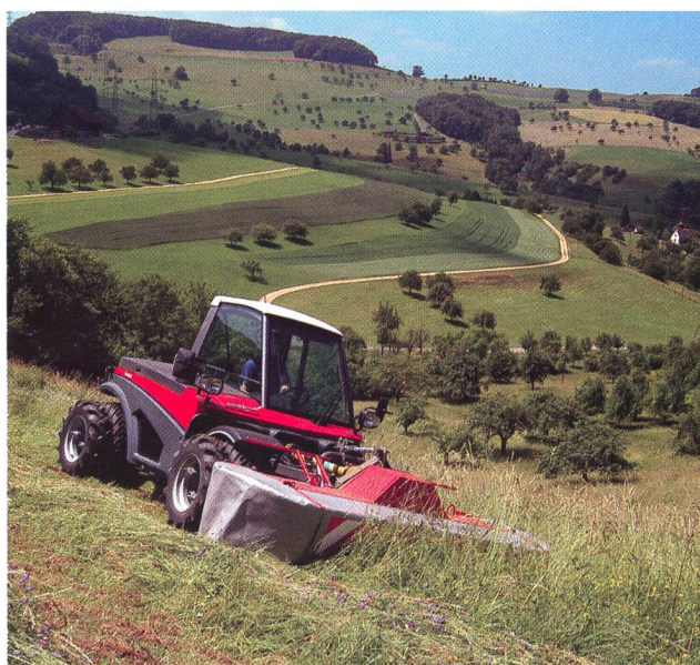
Aebi TT 170, machines compactes en action avec une faucheuse rotative. Les faucheuses à deux essieux deviennent toujours plus performantes, car elles peuvent utiliser des rotatives atteignant trois mètres de large.
