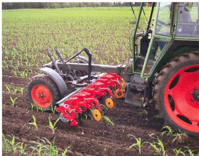
La sarcluse arracheuse et la sarcluse à doigts saisissent les mauvaises herbes également dans les rangs. Elles sont relativement onéreuses à l'achat et à l'entretien.
