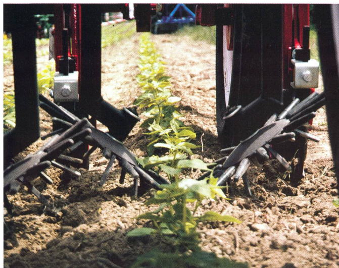
La sarcluse arracheuse et la sarcluse à doigts saisissent les mauvaises herbes également dans les rangs. Elles sont relativement onéreuses à l'achat et à l'entretien.
