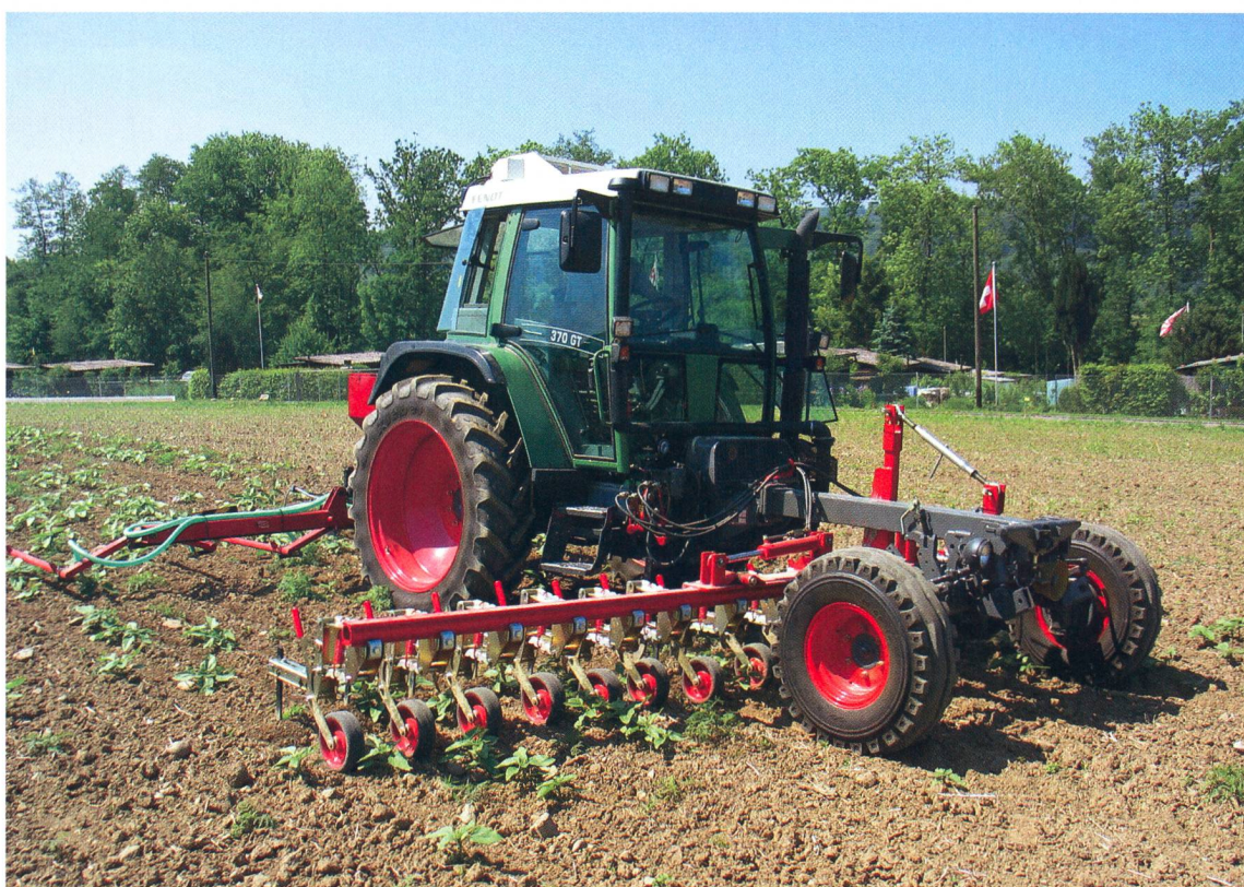
Sarcleuse à socs à l'avant, herse à l'arrière. Les outils de 6 ou même 9 m de largeur de travail augmentent les performances.
