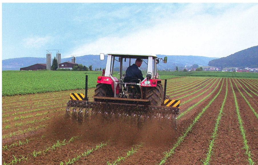
La sarceleuse roulante américaine brise la croûte de la surface du sol. Alors que les jeunes plantes de maïs supportent la machine sans dommage, les betteraves sucrières s'avèrent très sensibles.
