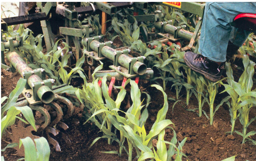
Sarcleuse étoile: l'outil idéal dans le maïs à hauteur de genou.
