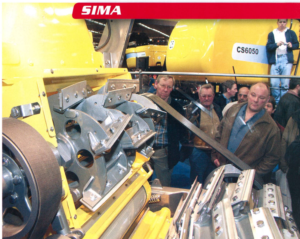
Ensileuse NH FR 9000: Changement de configuration très rapide entre le maïs ou les céréales humides et l'ensilage d'herbe grâce au système «Variflow».
