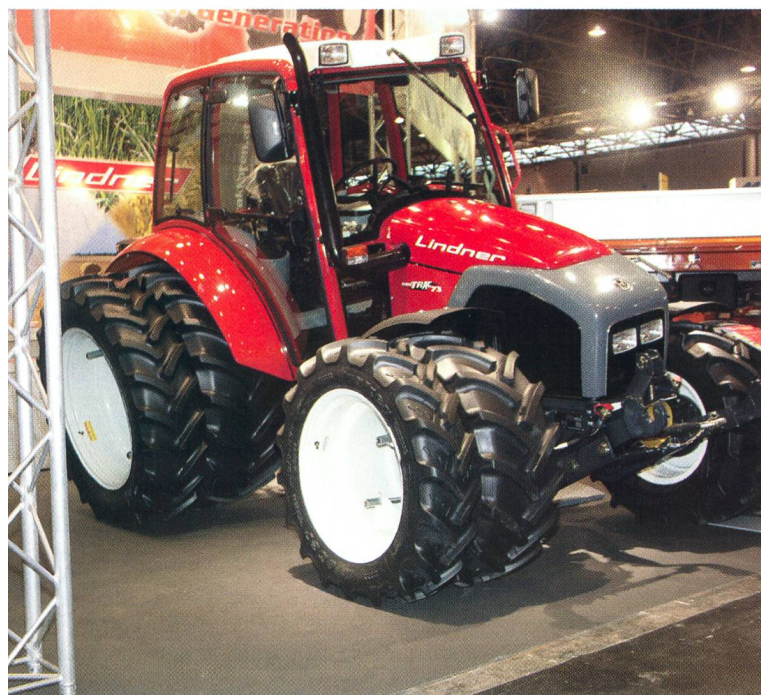
Lindner Geotrac: Ce ne sont pas seulement ses roues jumelées, mais également son système d'attache articulé de l'essieu avant qui le prédestinent à une utilisation en montagne.
