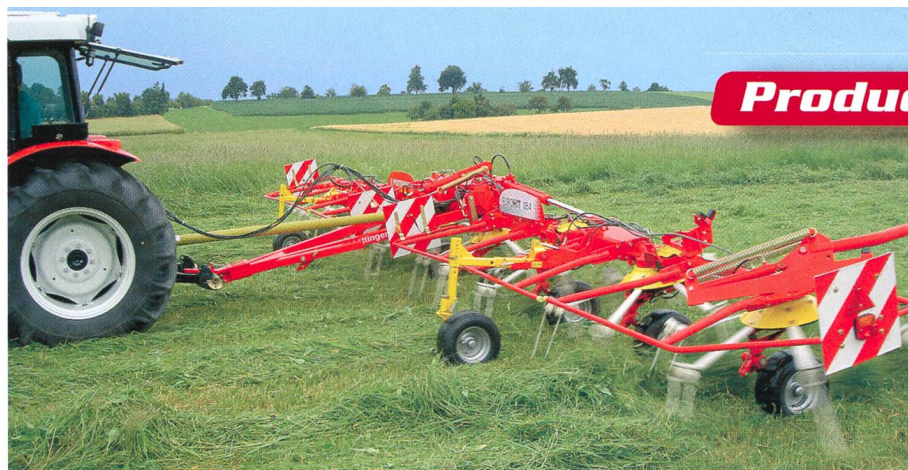
Pöttinger Eurohit 105 avec roue de jauge placée à l'avant pour une meilleure adaptation au sol (photo d'usine).
