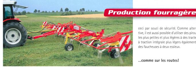
Pöttinger Eurohit 105 avec roue de jauge placée à l'avant pour une meilleure adaptation au sol (photo d'usine).
