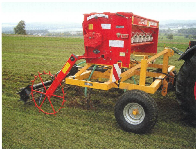
2. Semis direct de blé d'automne dans un peuplement de trèfle blanc avec un semoir équipé de socs piqueurs.
