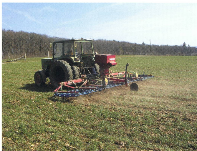
5. Combinaison réussie de lutte mécanique contre les adventices avec le semis d'une prairie artificielle.
