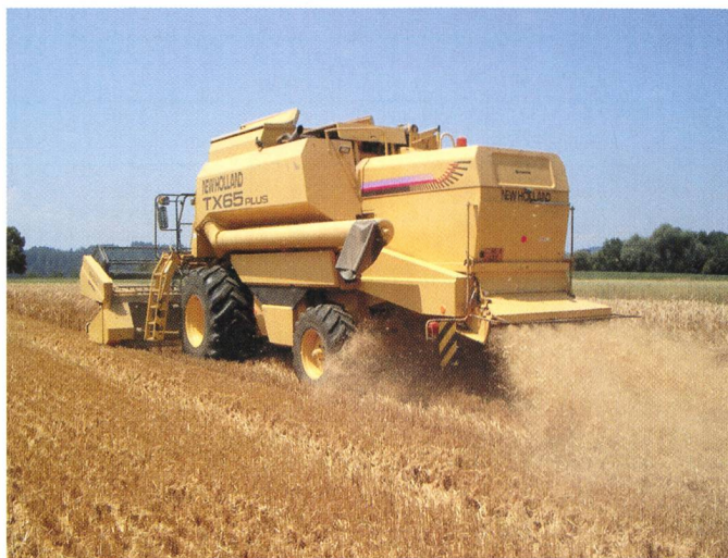
3. Un broyeur performant et un distributeur de glumes contribuent à répartir les restes de plantes sur toute la surface.
