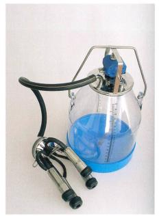
Le système de nettoyage des pots Strangko est intégré au cycle de nettoyage de l'installation de traite.
