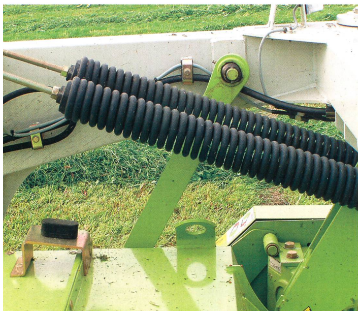
Deux ressorts à spirale servent à soutenir la faucheuse. Grâce à un pas de vis, le niveau de soutien peut être réglé. (Photo: R. Hunger)
