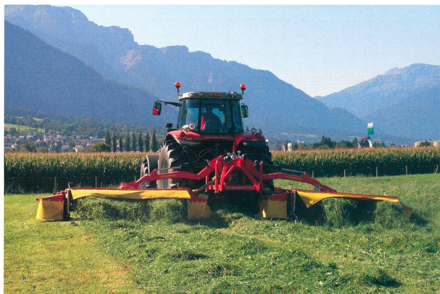
Les faucheuses attelées au centre nécessitent une construction complexe afin de ménager suffisamment d'amplitude pendulaire. (Photo: P. Wolf)
