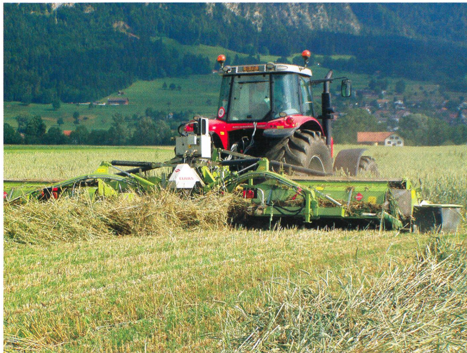
Le fourrage des deux faucheuses arrière est réuni avec l'endain de la faucheuse frontale. (Photo R. Hunger)
