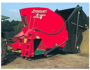
Remorque mélangeuse verticale tractée à autoremplissage Trioliet.
