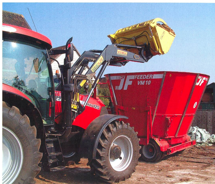
Stoll/JF ne construit que des mélangeuses verticales légères. Processus de chargement avec un frontal de la même marque.
