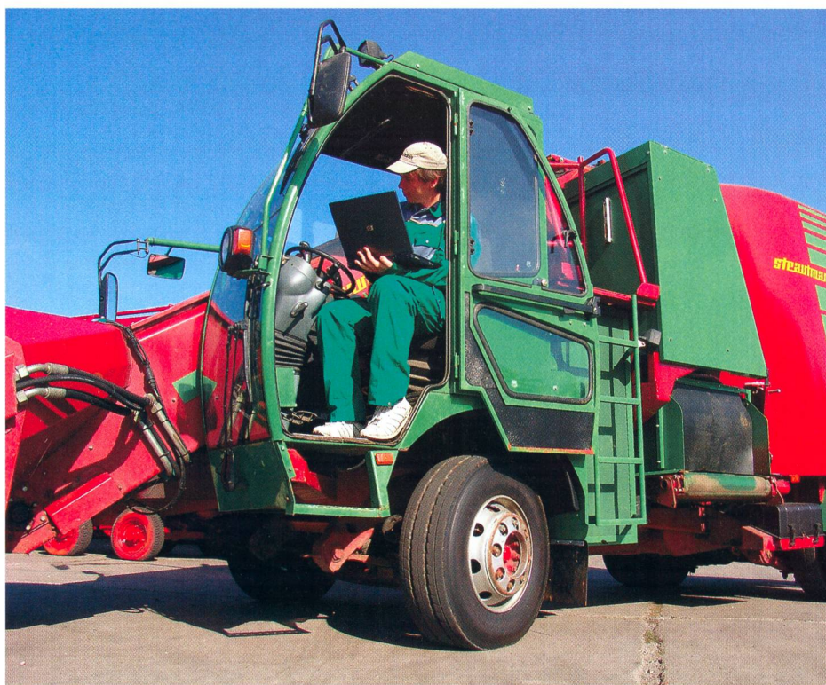
Strautmann attache une valeur particulière au suivi de ses produits. Mélangeuse verticale VertMix automotrice lors d'un contrôle électronique de ses fonctions.
