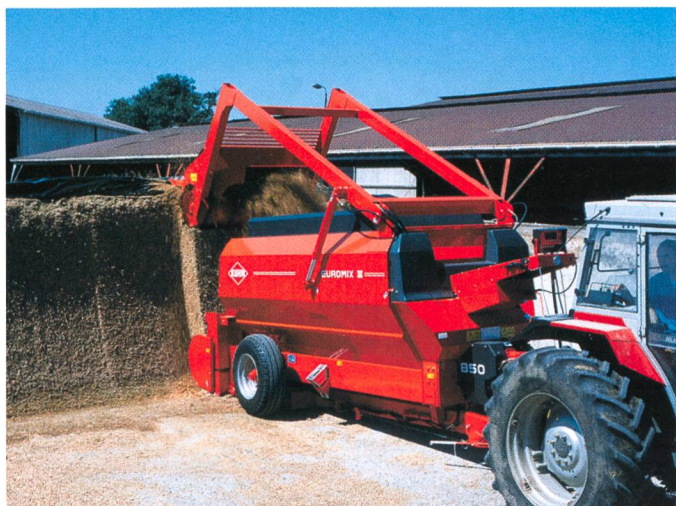
Remorque mélangeuse tractée à autoremplissage Kuhn Euromix II. Les mélangeuses horizontales ont une construction plus basse et s'avèrent souvent plus étroites.
