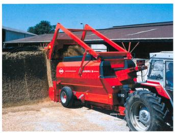
Remorque mélangeuse tractée à autoremplissage Kuhn Euromix II. Les mélangeuses horizontales ont une construction plus basse et s'avèrent souvent plus étroites.
