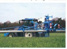
les buses. Les deux troncons de rampe externes peuvent éviter les obstacles en se déplaçant vers le haut et latéralement et permettent de continuer rapidement en retournant automatiquement dans leur position de travail.
