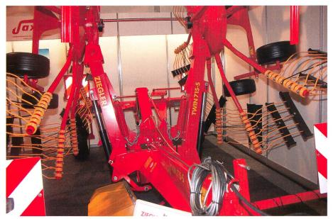
Technique relativement simple chez Ziegler: la machine se referme, les râteaux à double dents ne doivent pas être démontés pour les trajets routiers.
