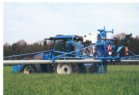
Pulvérisateur porté EuroLux 1200 TL avec rampe 21 m
